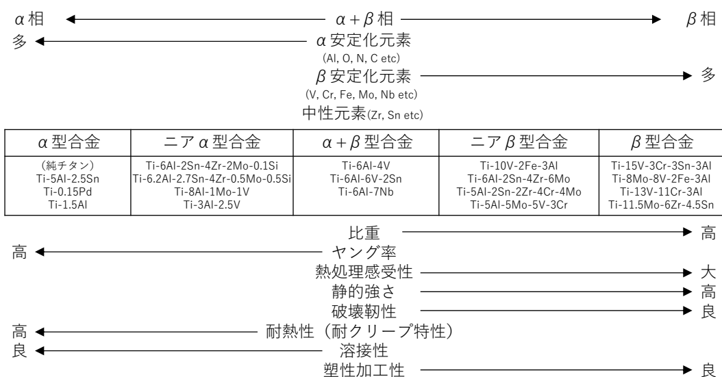
図1 各種チタン合金の構成相による分類とそれに伴う緒特性の傾向 (「チタンの基礎と応用」内田老鶴圃 (2023) 第2章2.1.2 P31 図2.3を参考に編集)
