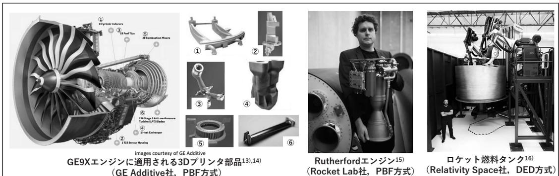
図 1 航空宇宙分野における金属3Dプリンタの適用例
