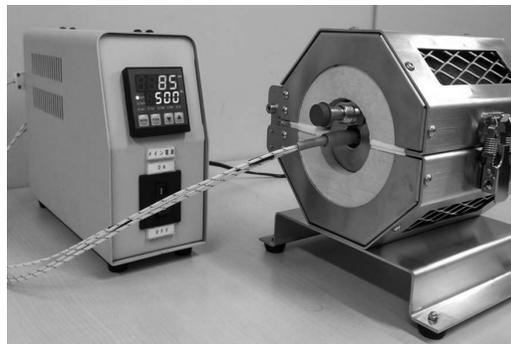
図 1 水素精製用分離膜モジュールのミニマムキット一式
