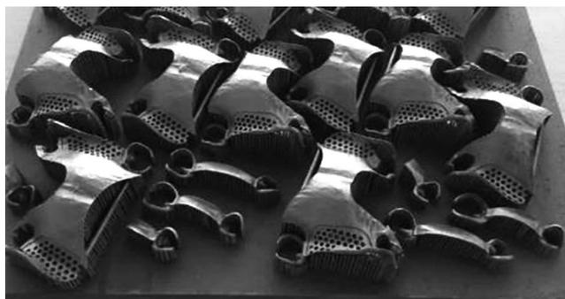
写真1 金属3Dプリンターで造形した多種類の歯科補綴物
