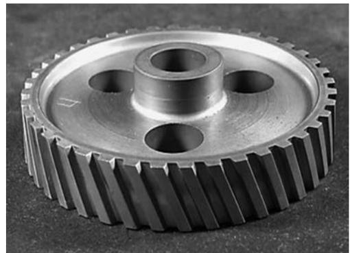
図 3 焼結冷間鍛造による外はすば歯車部品
