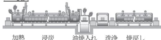
図1 マイルド浸炭の概要<sup>1)</sup>
