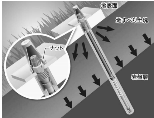
図 2 SEEEグラウンドアンカーの構造
